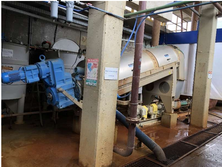
Figura 139: Centrifuga de Lodo.
