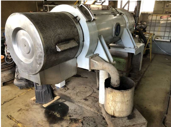
Figura 131: Centrifuga de Lodo.
